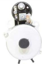
Anlasser passend für Linde (12 Volt; 9 Zähne; 3,0 KW) Deutz Motor
